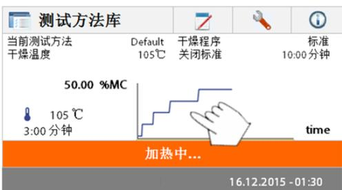
显示面板上显示测试名称，温度/时间，实际温度，已测试时间，水分和干燥曲线。测试结束后会自动停止。如果您想提前终止测试，请按
