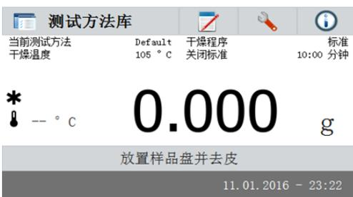
仪器显示默认的测试方法及其设置，可直接开始测试或按图示区域编辑设置。
